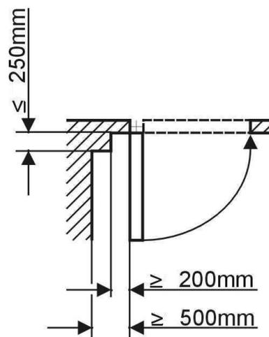
Abb. 5: Vermeiden von Quetschgefahr zum Schutz des Kopfbereiches
