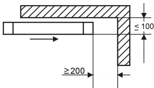
Abb. 2: Vermeiden von Quetschgefährdung zum Schutz des Kopfbereiches
