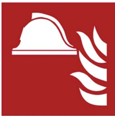
F004 Mittel und Geräte zur Brandbekämpfung
