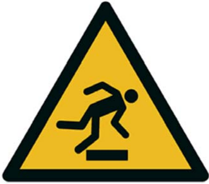
W007 Warnung vor Hindernissen am Boden
